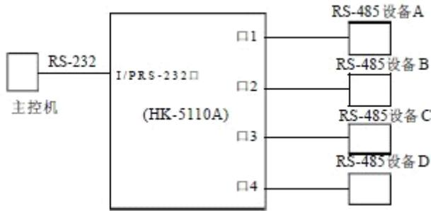
2、 已有 RS-485 总线扩展至 4 个高可靠性的 RS-485接口的应用, 在RS-485总线上可同时并连128个RS-485设备。
