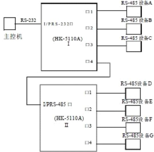
4、 已有 RS-485 总线扩展至多个高可靠性的 RS-485接口的应用,在RS-485总线上可同时并连128个 RS-485设备
